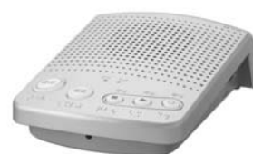
緊急地震速報を多施設に分配する IP告知端末
